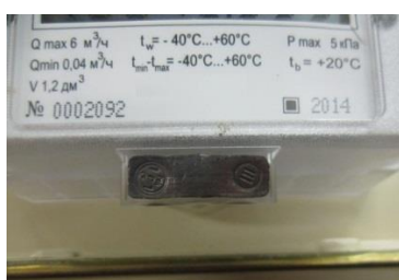
Рисунок 3 - Место пломбирования счетчика газа ОМЕГА ЭК
