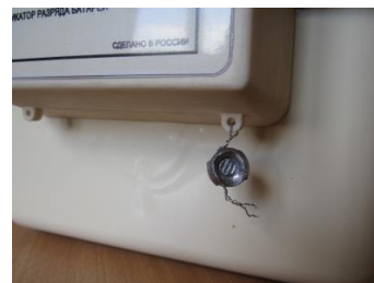
Рисунок 7 - Пломбирование крышки батарейного отсека ОМЕГА ЭК К
