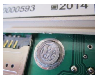
Рисунок 4 - Место пломбирования счетчика газа ОМЕГА ЭК К
