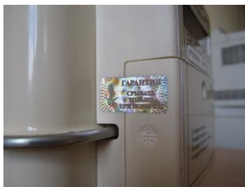
Рисунок 7 - Пломбирование крышки батарейного отсека ОМЕГА ЭК К
