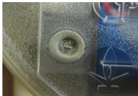
Рисунок 4 - Место пломбирования ОТК
