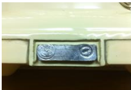
Рисунок 3 - Место пломбирования и нанесения знака поверки
