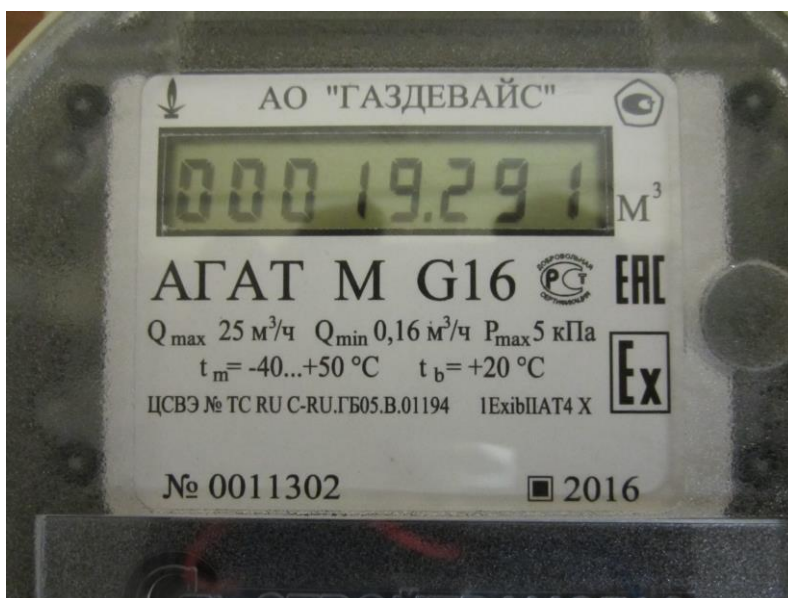
Рисунок 2 - Маркировочная табличка счетчика газа
